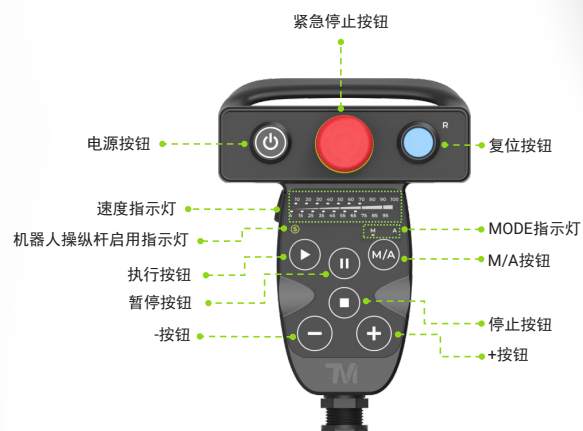
图25: 机器人操纵杆（正面）
